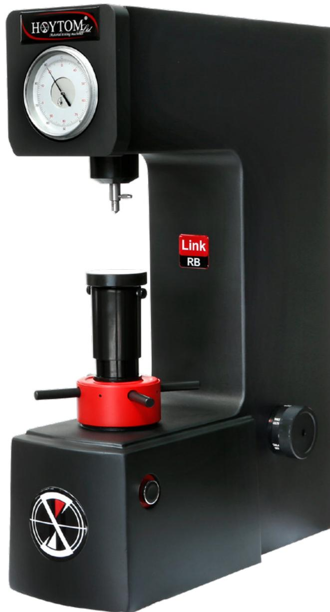
El modelo Link RB es un durómetro Rockwell que puede aplicar cargas de 60, 100 y 150 Kg. Además dispone de cargas adicionales para ensayos Brinell (31.25, 62.5 y 187.5 Kg).
