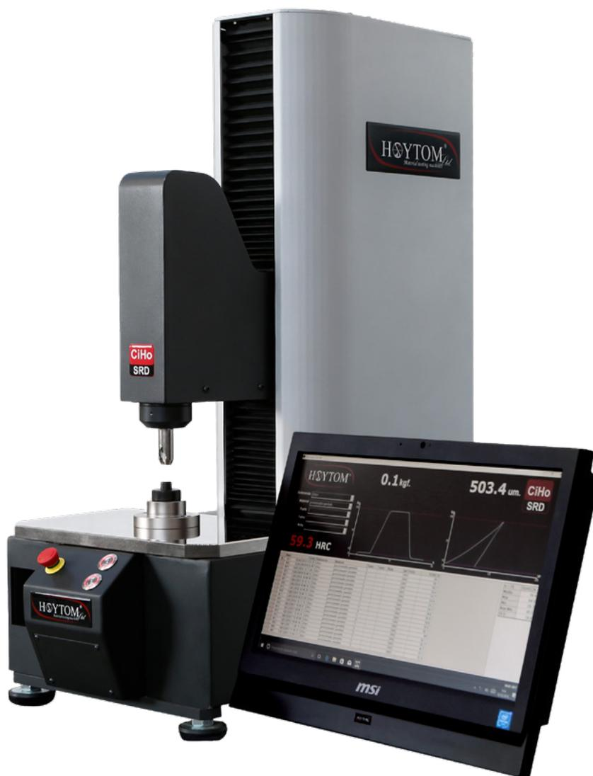
Este modelo ha sido desarrollado para realizar ensayos Rockwell (con cargas de 60, 100 y 150 kp) y Rockwell Superficiales (cargas de 15, 30 y 45 kp), pero además dispone de cargas adicionales que le permiten realizar otros ensayos como Brinell o Vickers. Está formado por un bastidor motorizado, en donde se instalan los sistemas de aplicación de cargas (usando transductor de fuerza controlado por procesador).
