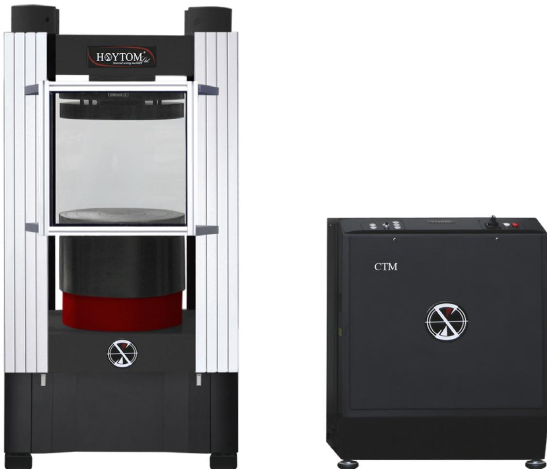
La prensa hidráulica modelo CTM, que pertenece a la serie PRO de HOYTOM, puede alcanzar capacidades nominales de hasta 6.000 kN. Este equipo está especialmente diseñado para realizar ensayos a compresión de probetas de hormigón cilíndricas, cúbicas y prismáticas, así como ensayos de tracción indirecta, cumpliendo con las normas correspondientes.
