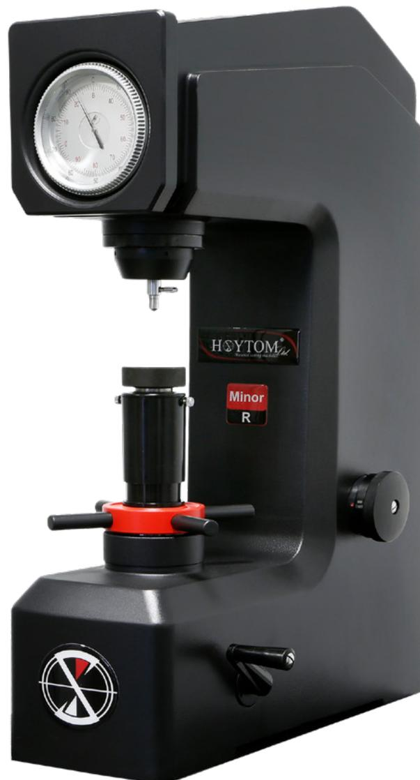
Los modelos Minor-R y Minor-S son durómetros de uso rápido y sencillo, que permiten realizar lecturas directas en escala Rockwell y Rockwell superficial respectivamente.
