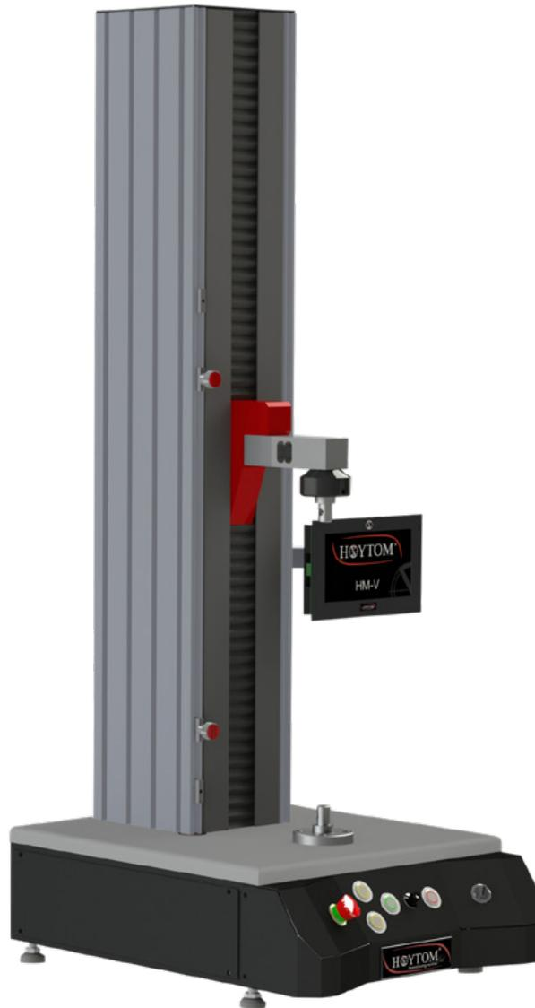
El modelo HM-V, que pertenece a la serie PRO de Hoytom, se fabrica para capacidades nominales de hasta 5 kN. Además, puede equiparse con una gran variedad de utillajes como mordazas de tracción, placas ranuradas en T, platos de compresión, útiles de flexión, extensómetros, etc.
