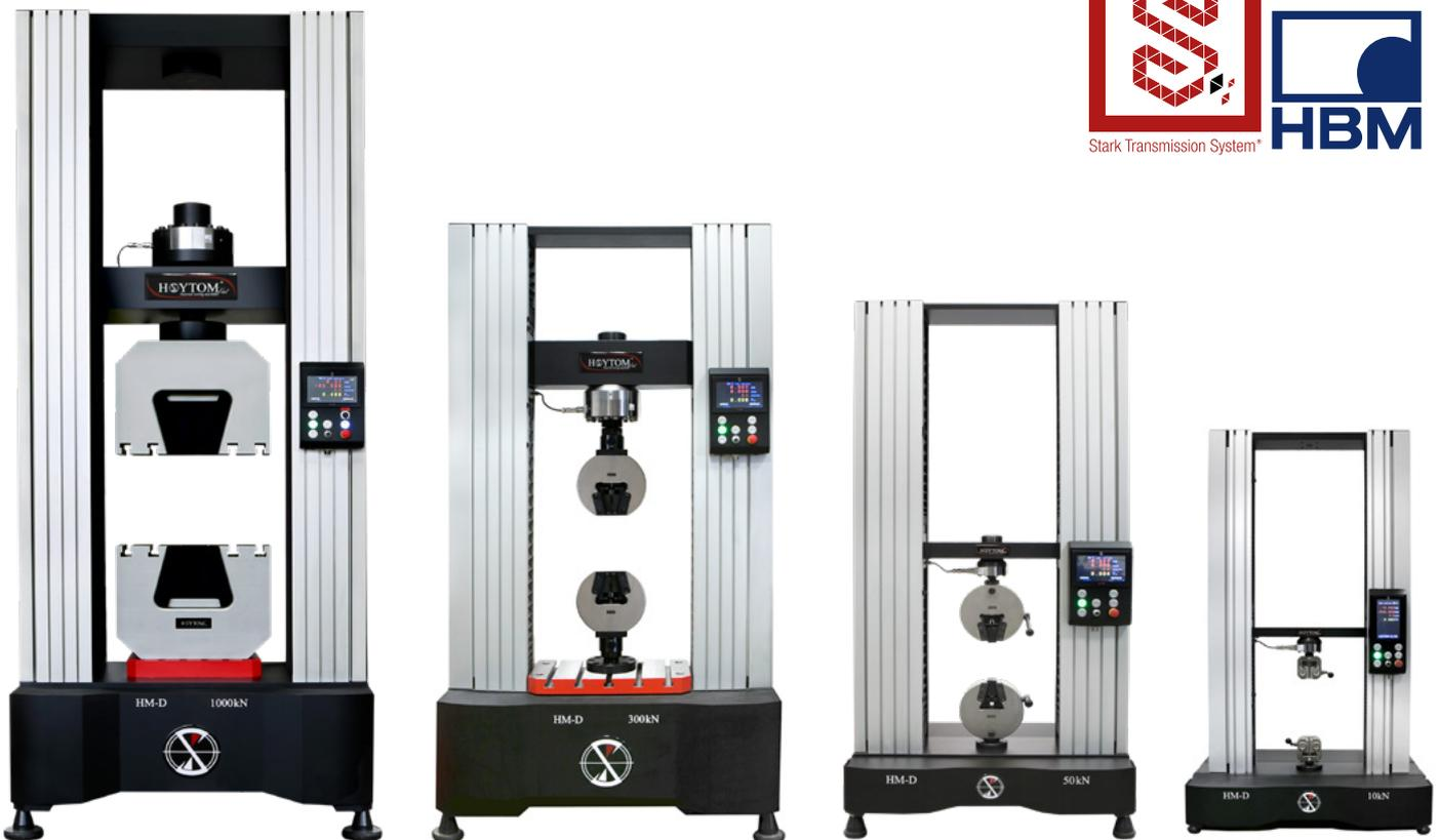
El modelo HM-D, que pertenece a la serie LAB de Hoytom, se fabrica para capacidades nominales de entre 5 y 1000 kN. Su célula de carga de alta calidad permite la máxima precisión en todo el rango de medida. Además, puede equiparse con una gran variedad de utillajes como mordazas de tracción, placas ranuradas en T, platos de compresión, útiles de flexión, extensómetros, etc.
