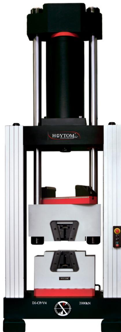
El modelo DI-CP/V4, que pertenece a la serie PRO, está diseñado para realizar ensayos de tracción, compresión, flexión y cizalladura, con capacidades nominales de entre 400 y 2000 kN. La tracción siempre se realiza mediante las mordazas hidráulicas que se encuentran en el área inferior, y la compresión en el área superior de ensayos.
