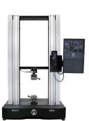
El modelo HM-D, que pertenece a la serie LAB de Hoytom, se fabrica para capacidades nominales de entre 5 y 1000 kN. Su célula de carga de alta calidad permite la máxima precisión en todo el rango de medida. Además, puede equiparse con una gran variedad de utillajes como mordazas de tracción, placas ranuradas en T, platos de compresión, útiles de flexión, extensómetros, etc.
