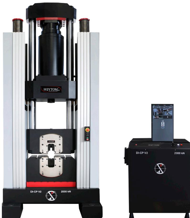
El modelo DI-CP/V2, que pertenece a la serie PRO, está diseñado para realizar ensayos de tracción, compresión, flexión y cizalladura, con capacidades nominales de entre 1500 y 2000 kN. La tracción siempre se realiza mediante las mordazas hidráulicas que se encuentran en el área inferior, y la compresión en el área superior de ensayos.
