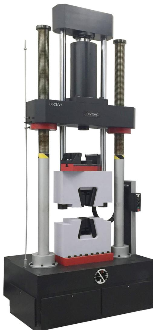
El modelo DI-CP/V2, que pertenece a la serie PRO, está diseñado para realizar ensayos de tracción, compresión, flexión y cizalladura, con capacidades nominales de entre 1500 y 2000 kN. La tracción siempre se realiza mediante las mordazas hidráulicas que se encuentran en el área inferior, y la compresión en el área superior de ensayos.
