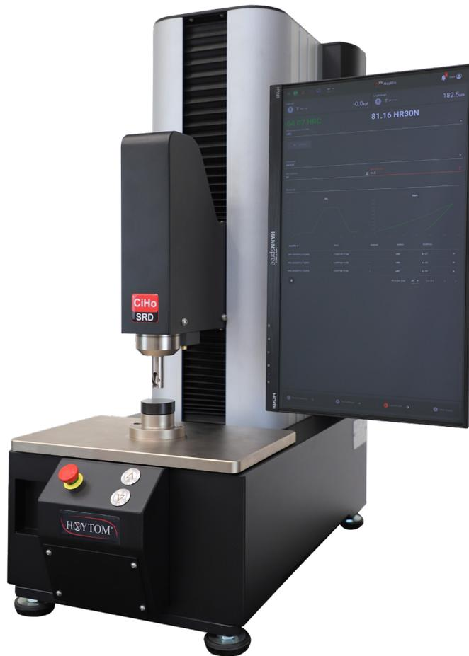
Este modelo ha sido desarrollado para realizar ensayos Rockwell (con cargas de 60, 100 y 150 kp) y Rockwell Superficiales (cargas de 15, 30 y 45 kp), pero además dispone de cargas adicionales que le permiten realizar otros ensayos como Brinell y Vickers. Está formado por un bastidor motorizado, en donde se instalan los sistemas de aplicación de cargas (usando transductor de fuerza controlado por procesador).
