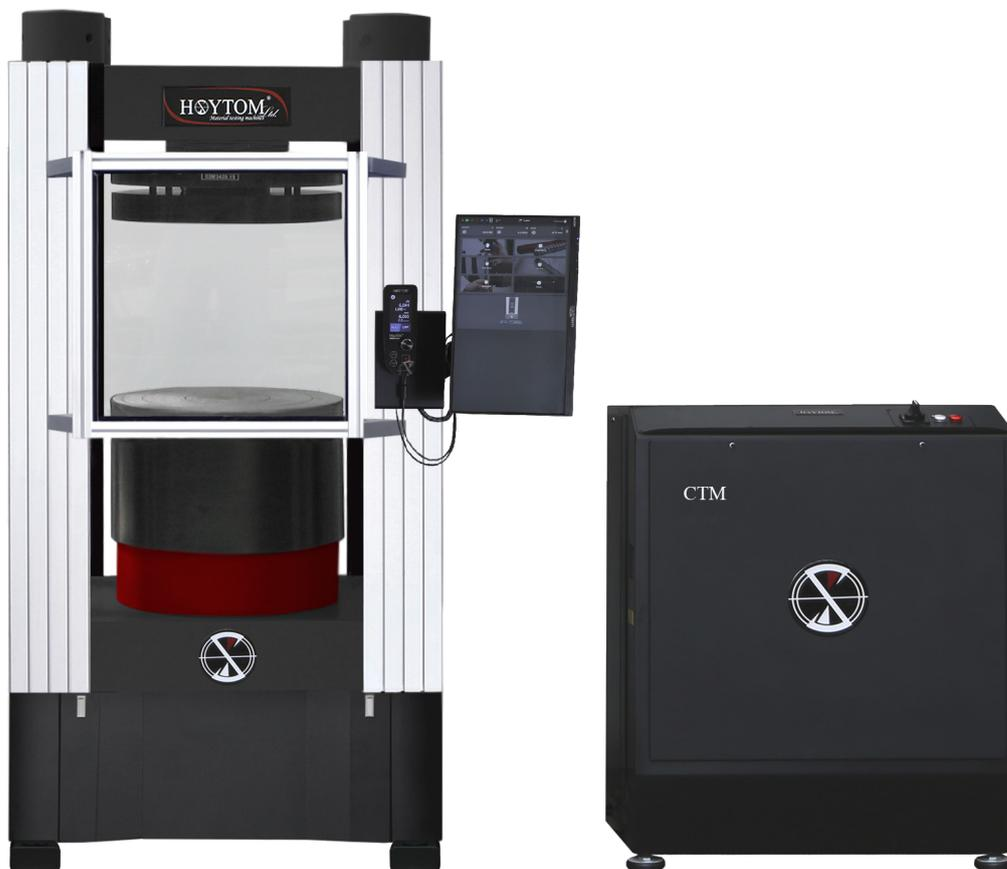
Die Hydraulikpresse Modell CTM gehört zu Hoytom PRO Series und erreicht Nennkapazitäten bis zu 6000 kN. Diese Maschine wurde speziell für Kompressionsprüfungen von zylindrischen, würfelförmigen und prismenförmigen Betonprüfstücken sowie indirekte Zugprüfungen unter Einhaltung der entsprechenden Normen entwickelt.
