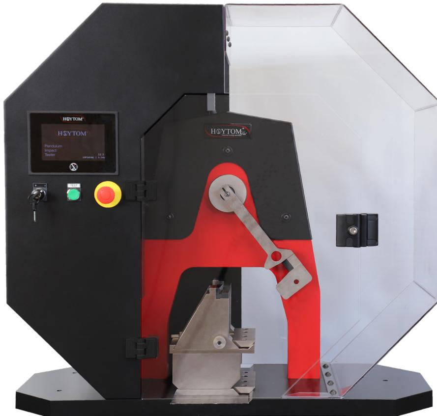
El péndulo de impacto de sobremesa de Hoytom está diseñado para realizar ensayos sobre plásticos y composites según las normas Charpy o Izod.
