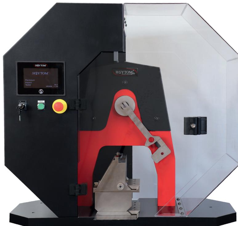
Der Hoytom-Pendelhammer als Tischgerät wurde zur Durchführung von Prüfungen nach den Normen von Charpy und Izod mit Kunststoff- und Verbundstoffprüfstücken entworfen.
