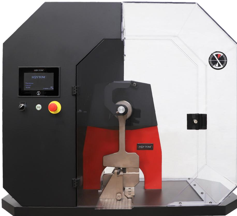
El péndulo de impacto de sobremesa de Hoytom está diseñado para realizar ensayos sobre plásticos y composites según las normas Charpy o Izod.
