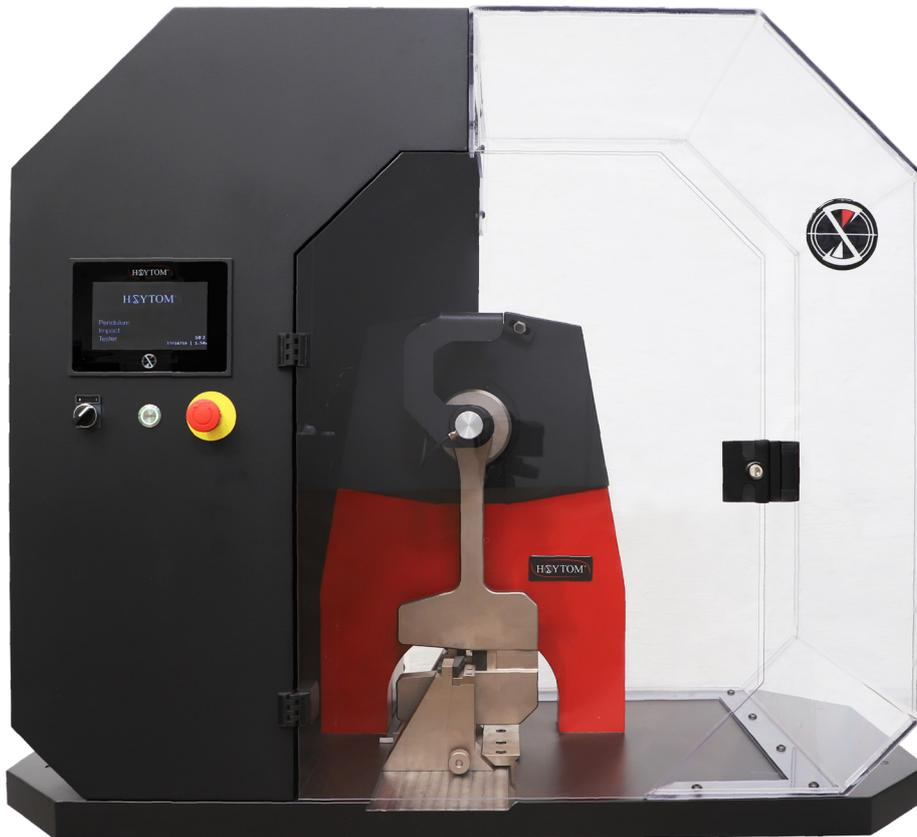
Der Hoytom-Pendelhammer als Tischgerät wurde zur Durchführung von Prüfungen nach den Normen von Charpy und Izod mit Kunststoff- und Verbundstoffprüfstücken entworfen.
