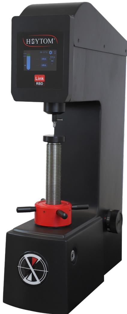
El modelo Link RBD es un durómetro Rockwell que puede aplicar cargas de 60, 100 y 150 Kg. Además dispone de cargas adicionales para ensayos Brinell (31.25, 62.5 y 187.5 Kg).
